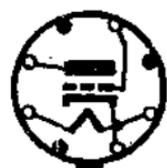
左圖中所示各型號的電子管電極引綫，是以該管的底座自下向上觀看為依據。某些特殊電子管是以箭頭上下的方向表示電子管上下端的引綫。
