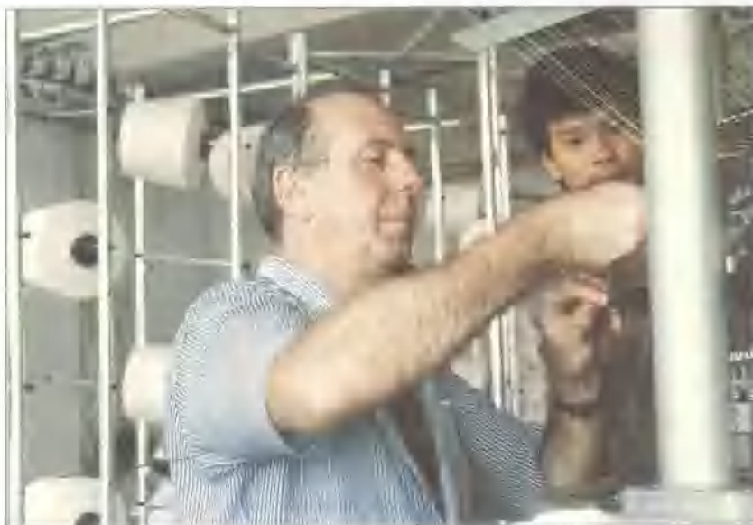
德國專家在市針織廠安裝針織大圓機。
