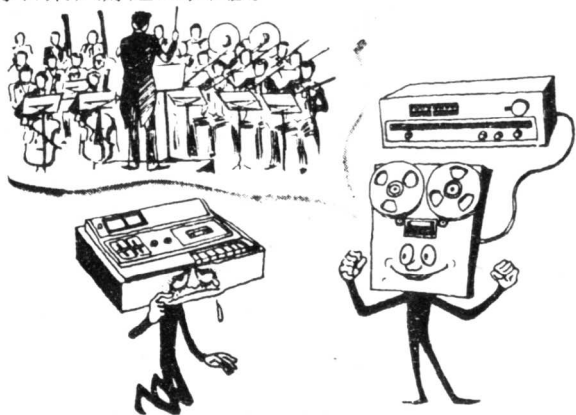
插圖 1-2 現場廣播交響樂時，從無線電錄製音樂帶的時候，使用盤式錄音座比使用卡式錄音座，更容易收得高品質的錄音
