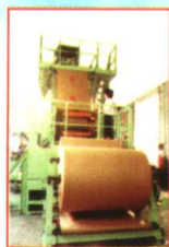
▲ 本公司引进德国先进技术研制开发的 FEB50—I型电脑控制自动制袋生产线
