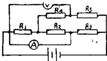
四、(9分)如图每节电池的电动势为1.5伏，内电阻为 $0.3\Omega$ ， $R_1 = R_2 = R_3 = 4\Omega$ ，
