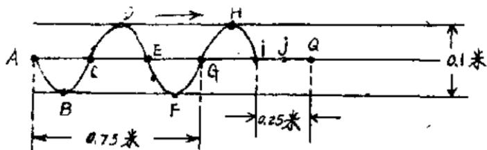
质点Q才开始振动 1 秒, 向那个方向振动 右。
