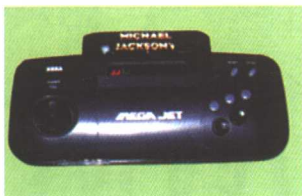
↑与JAL航空合作的新机种，用的同样是MD的卡带。机身只有按键和卡带插槽，要玩游戏的话得接上飞机座位内的小屏幕才行。
