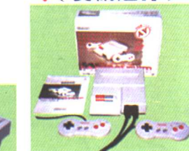
↑1993年与“塞尔达传说1”（卡带版）同时发售的新机种。香去十几年来的红白造型，改为模仿自SFC的机身。另外，AV端子无法使用以往传统的“三头式”。
