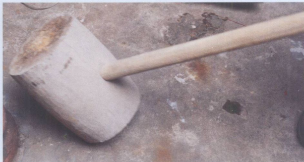
图8 图为打桩用的鐮锤
