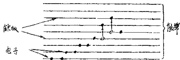
图(1) 当电子参加导电运动时，它就从下面较低的能级跳到上面的空能级上去。
