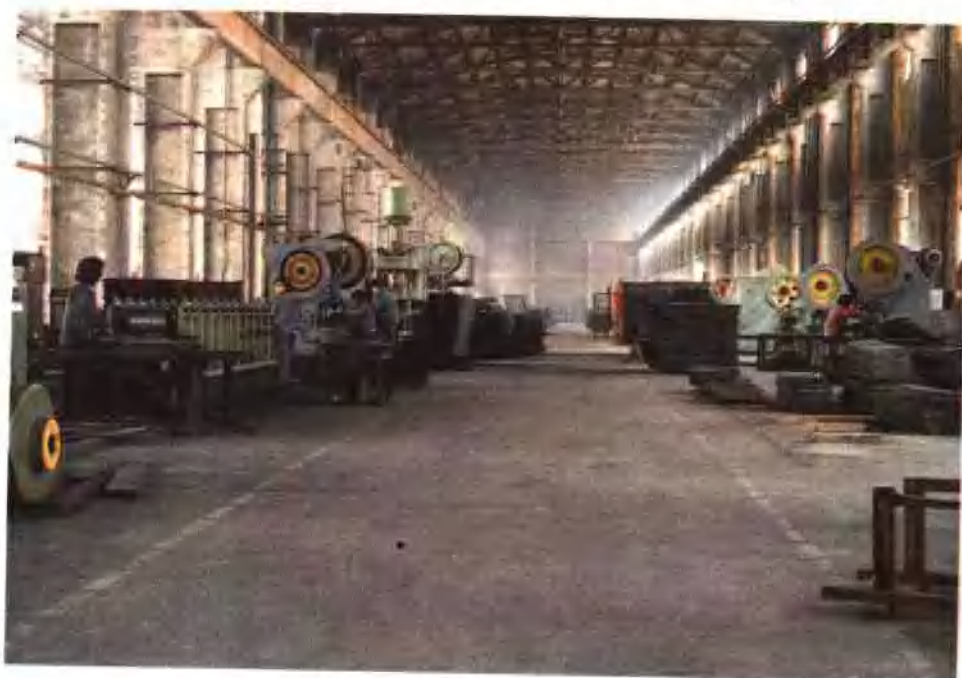
图 3—10 模板车间北跨，近处为国内最新研制的建筑用钢模板槽棱连轧机生产线
