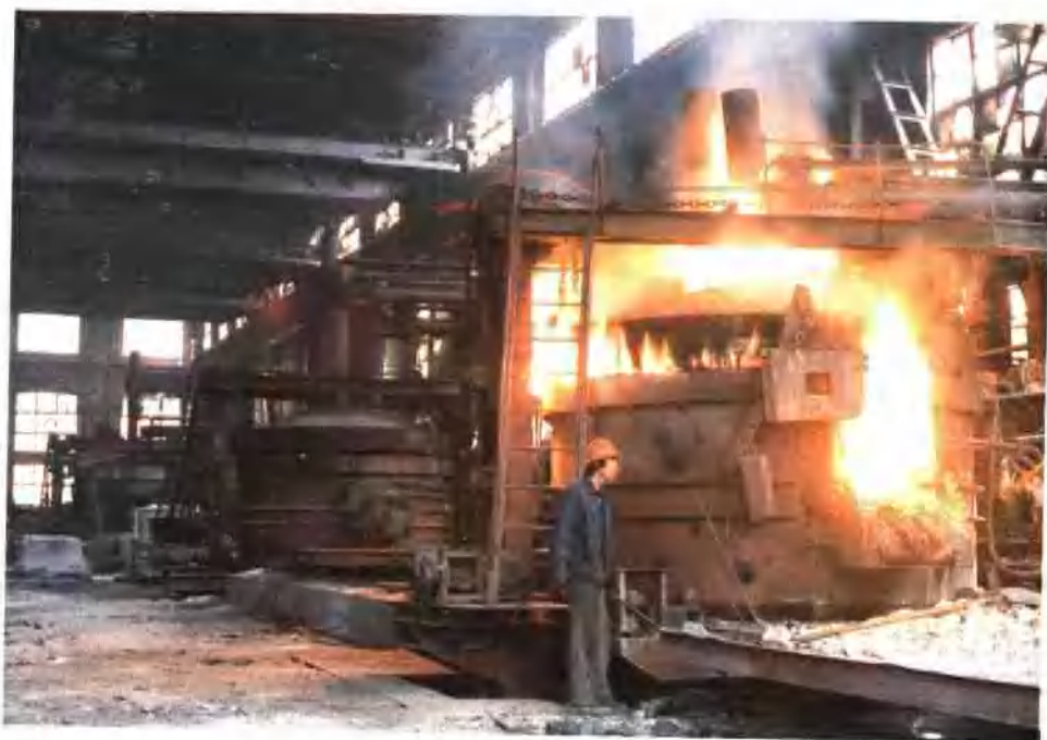
图 3—1 炼钢车间电炉群
