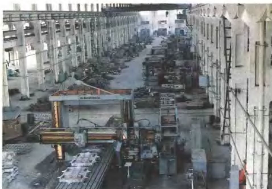
图 3—8 金工车间内景，近处为日本进口的十米龙门刨
