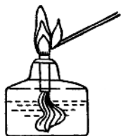
圖 1 甲 正確的點火法
