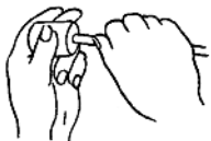
圖 21 往塞內穿入玻管(正確的)
