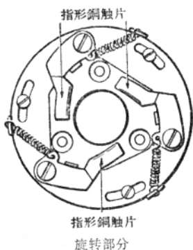
图 1.9 离心开关的旋转部分和静止部分
