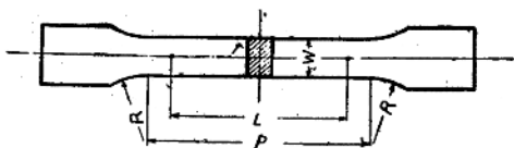
圖內：標點距離 L=50\text{ mm} 平行部之長度 P=60\text{ mm} 寬度 W=25\text{ mm} 角部之半徑 R=15\text{ mm} 以上
