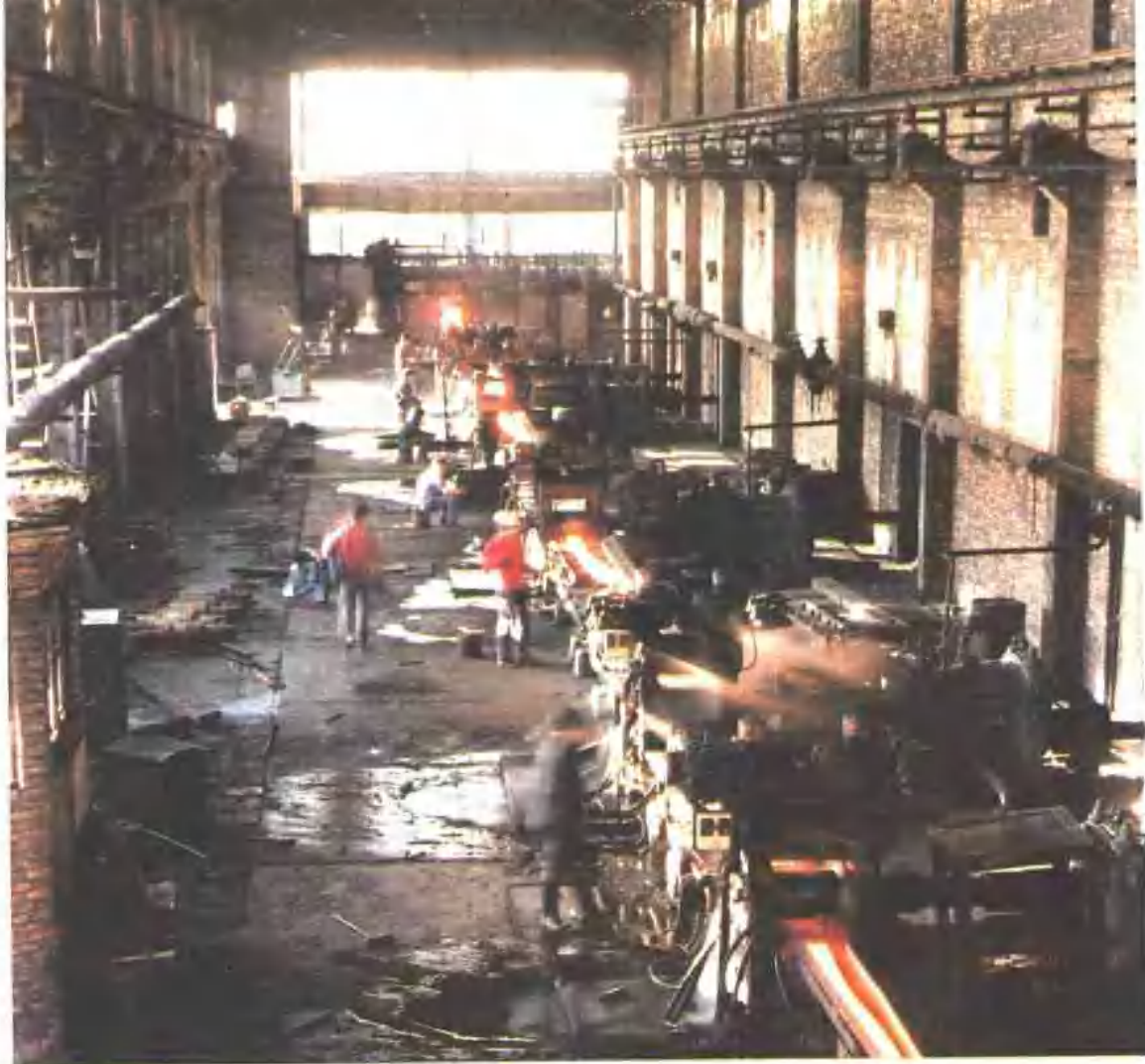
300 mm 轧机进行 热轧带钢 生产
