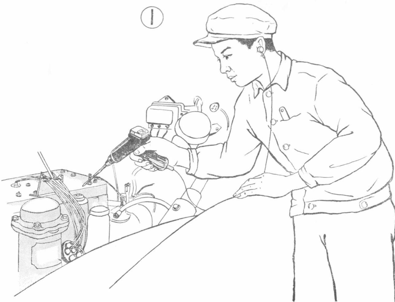
察听发动机的声响是一项重要的工作，因为发动机的声响是衡量其技术状况的一个重要指标。发动机出现异常响声时，如不及时检修，会引起严重损坏，而及时将其消除，则可能延长发动机的使用寿命。
