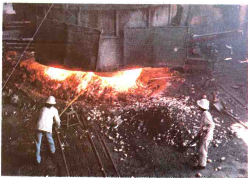
全省现有 3200 千伏安硅铁电炉 2 座，2700 千伏安硅锰电炉 1 座。1983 年，新余钢铁厂在电炉上进行了上部炉体旋转工艺 试验，获 1984 年冶金工业部 科技成果四等奖和江西省优秀科技成果二等奖。图为硅铁电炉正在生产。
