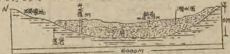
鄂托克旗经红加勒图西一个洼地水文地质剖面示意图
