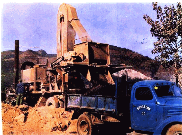
遵化县交通局自制的油石拌合机在生产中
