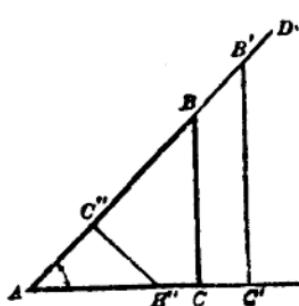
AD 上取任意點 B, B', B'', 作 AE 之垂線 BC, B'C', B''C''；又在 AE 上取任意點 C'', 作 AD 上之垂線 B''C''。則構成一組相似三角形 ACB, AC'B', AC''B''。此等相似三角形之對應邊成比例，即
