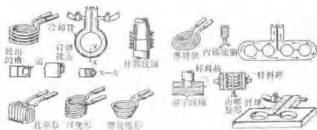
图 1.6 典型的感应钎焊线圈
