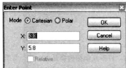
您可以选择用直角坐标（*Cartesian*）或极坐标（*Polar*）的方式输入坐标值。后者的基点为系统坐标原点。其角度为 X 轴和矢径的夹角，矢径（*Radius*）为原点到点的距离。
