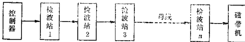
图 1 串联式有线数据传输结构图
