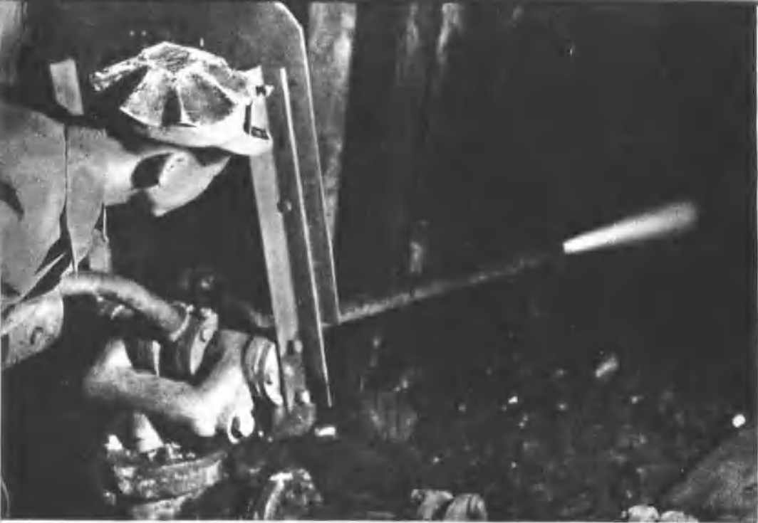
安州煤礦青年工人採用水力採煤法採煤
