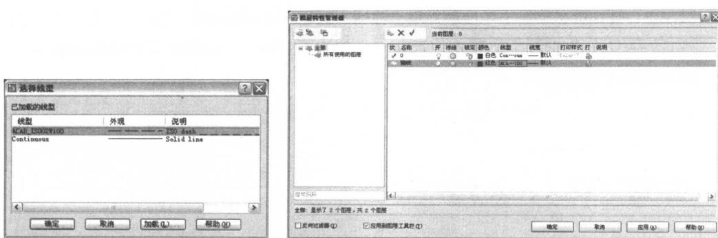
根据以上方法，结合示意图，设置各层的名称、颜色和线型。设置完成后，将轴线层设为当前层。完成效果如图所示。
