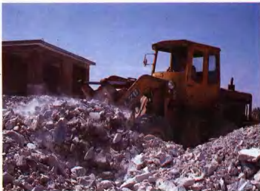
矿山装载机在堆矿场向原矿仓装运矿石
