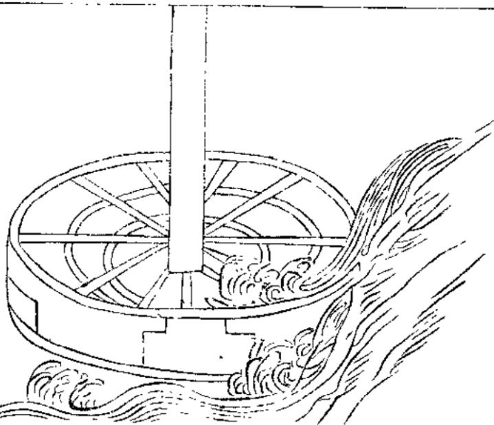
水輪三事。謂水轉輪軸。可兼三事。磨礱碾也。初則置立水磨。變麥作麪。一如常法。復于磨之外周。造碾圓槽。如欲穀米。惟就水輪軸首。易磨置礱。既得穉米。則去礱置碾。礱。榦循槽碾之。乃成熟米。夫一機三事。始終俱備。變而能通。兼而不乏。省而有要。誠便民之活法。造物之潛機。今創此制。幸識者述焉。詩云。制磨元憑一水輪。就加礱碾巧相因。軸端更平聲。置皆從省。穀物兼成。豈憚頻餅食。已供無匱乏。米珠重。造得圓匀。濟民有要。無人識。農譜圖中。擬細陳。
