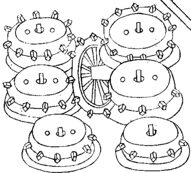
水聲切<sub>董</sub>水轉聲薯也。礪制上同。但下置輪軸。以水激之一。如水磨。日夜所破穀數可倍人畜之力。水利中未有此制。今特造立。庶臨流之家。以憑倣用。可爲永利。詩云。旋輪櫧穀入輕籠。役水還將與礮<sub>五對</sub>。同粒米精粗來有自。輪樞日復轉。無窮工傭。給貯何多暇。杵臼承春祇半功。仰<sub>去</sub>食老農方聽說。江鄉新制要相通。
