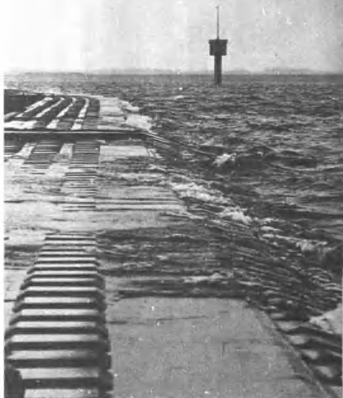
▲现场观测站 氢离子浓度和水位（分上，中，下三层）由相隔40公里的10个观测站同时进行测量。测量结果以无线电传输到管理所（使用太阳电池为电源）。
