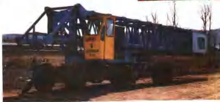
中图：该厂生产的塔式起重机可整体运输。
