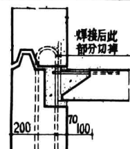
• 外墙板与楼面板节点 (无阳台处) 平面与剖面
