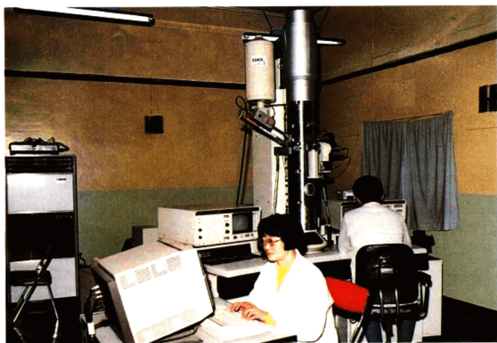
有效放大倍率达60万倍的H-800透视电子显微镜
