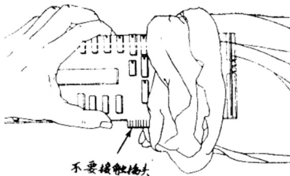
3 当将选件适配器安装到系统板上去时，应握在适配器顶部边缘或上面边角处。
