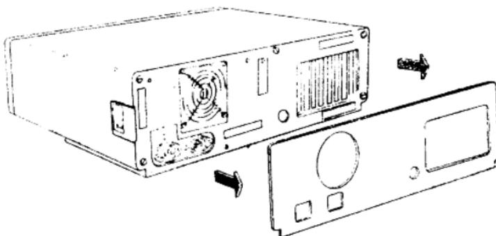
7 取下五个箱盖安装螺钉。
