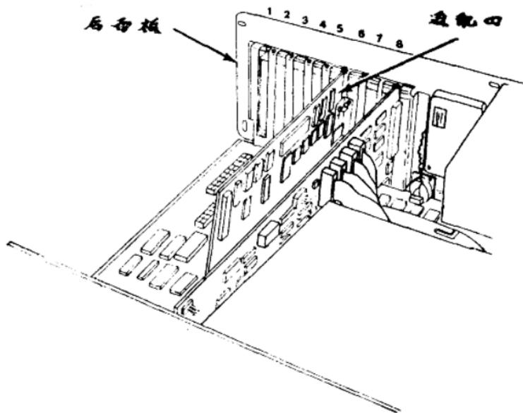
2 取下固定适配器的螺钉，保存好螺钉，为以后再安装此适配器。
