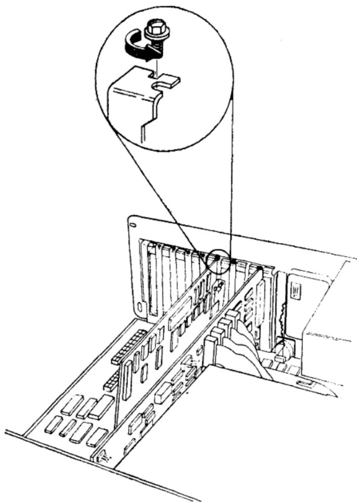
3 握住适配器顶部，然后将它拔出。对取下适配器的每一扩充槽均要作一标号。
