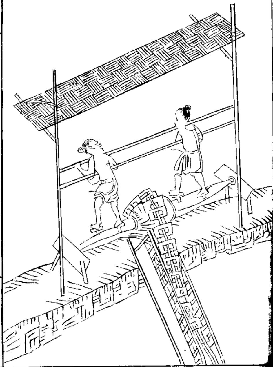
翻車通輞今人謂龍骨車也魏畧曰馬鈞居京都城內有地可爲園無水以灌之乃作翻車令兒童轉轆之而灌水自覆漢靈帝使畢嵒作翻車設機引水洒南北郊路則翻車之制又起于畢嵒矣今農家用之溉田其車之制除壓欄木及列檻椿外車身用板條槽長可二丈闊則不等或四寸至七寸案四寸七寸太狹疑有誤制高約一尺槽中架行道板一條隨槽闊狹比槽板兩頭俱短一尺用置大小輪軸同行道板上下通週以龍骨板葉其在上大軸兩端各帶拐木四莖置於岸上木架之間架憑人上踏動拐木則龍骨板隨轉去循環行道板刮水上岸此車闊橿頗多必用木匠可易成造其起水之法若岸高三丈有餘可用三車中間去聲小池倒都曉切水上之足救三丈已上高旱之田凡臨水地段皆可置用但田高則多費人力如數家相助計日趨工復可濟旱水具中機械巧捷惟此爲最東坡詩云翻翻聯聯銜尾鴉攀呂角攀切確確蛻骨蛇分畦翠浪走雲陣刺水綠秧抽稻芽洞庭五月欲飛沙鼉鳴窟中如打衙天公不念老農泣喚取阿香推雷車
