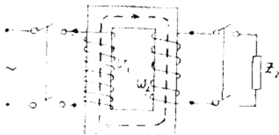
图 1—1 单相变压器的基本线路图
