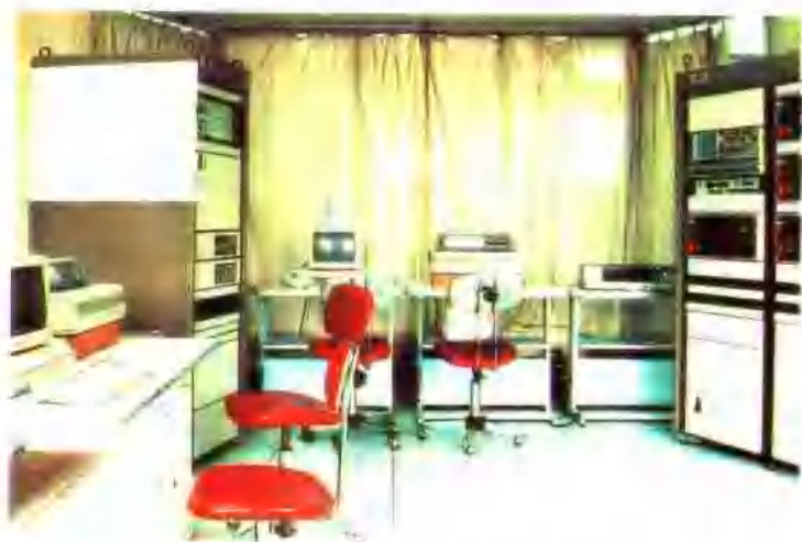
MTS 结构试验系统的控制部分
