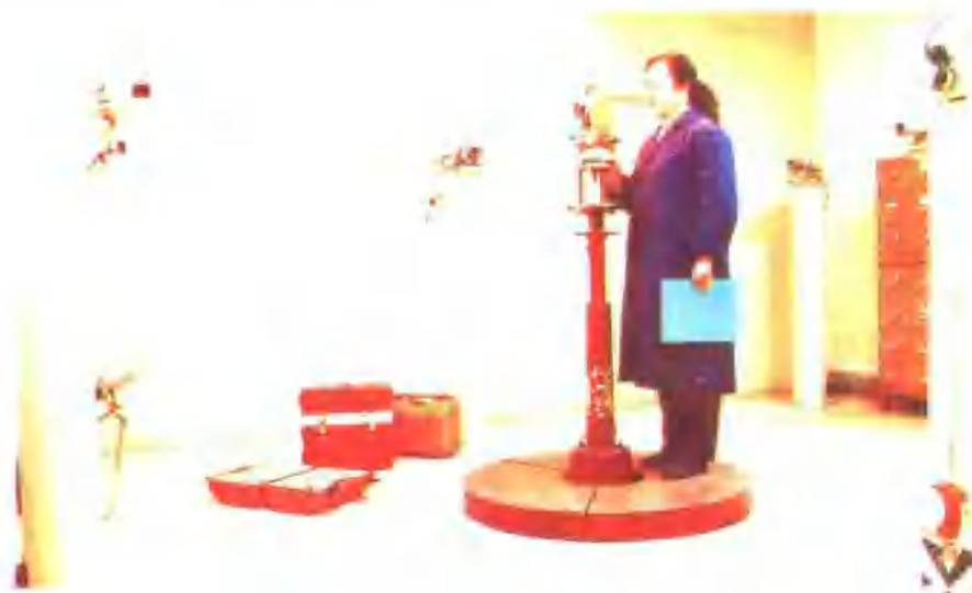
实验人员在检测室用平行光管组检测经纬仪
