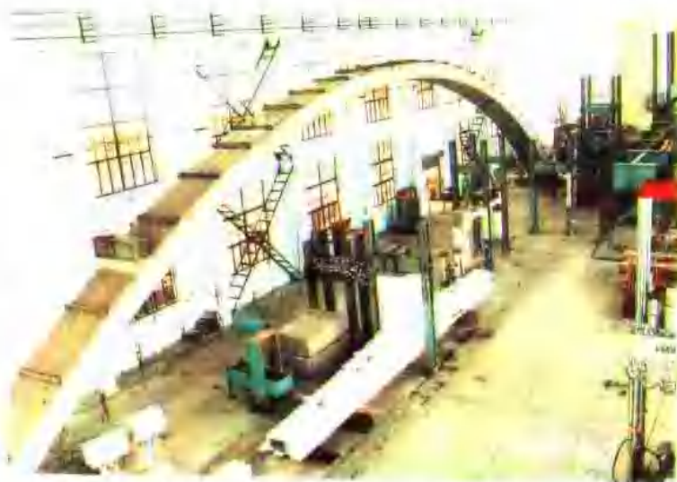
万县长江公路大桥 1:10 的模型实验
