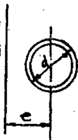
图 3 水冷壁管中心与炉墙的距离
