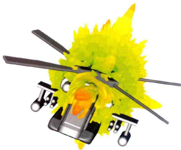
1GHz下阿帕奇直升机的RCS三维散射方向图
