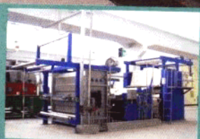
ZLYS991 型橡胶预缩机 本机供纯棉、麻及其混纺织物进行预缩整理并改善织物手感和光泽，使其具有良好的尺寸稳定性。
