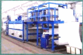
热风打底、热溶染色机 本机供涤棉织物热溶染色打底，也供棉布士林、还原染料悬浮体轧染打底。
