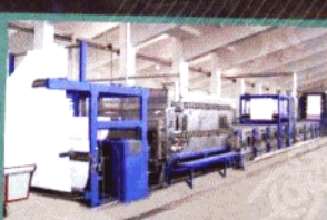
ZLQZRS991 型浸轧汽蒸染色机 本机供纯棉、麻、化纤及混纺织物进行染色和印花后的处理。
