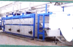
ZBH991 型焙烘机 本机供涤纶织物分散染料高温焙烘。
