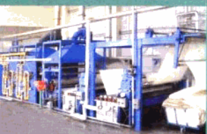
LMH005J型棉布烧毛机 本机供棉、麻织物的烧毛，以除去织物表面的杂质和茸毛。
