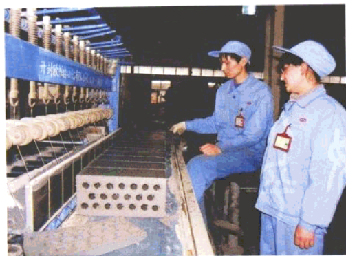
循环经济示范企业—华韵新型建材有限公司煤矸石烧结砖生产线
