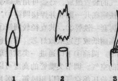
图5 正常火焰 临空火焰 侵入火焰
