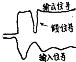
图5 无 D_1 、 D_2 时的输入输出波形 由于输入有反向过冲会造成输出有假信号
