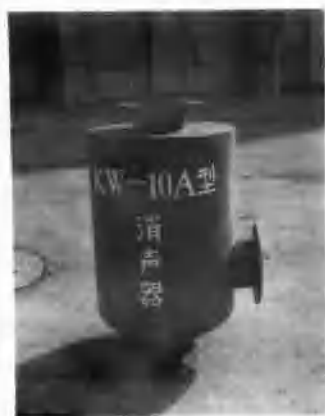
图3a KW-10A 文氏消声器
