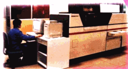
桌面出版系统与 SG-737 电分机联网
