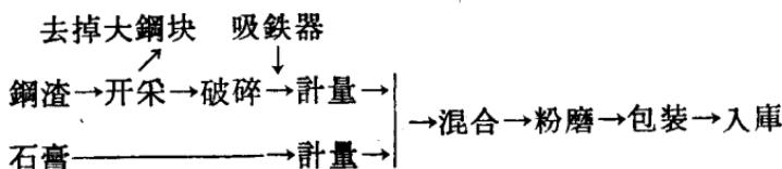
硬鋼渣用爆破法、落錘法或其他方法开采后，破碎至球磨机所要求的进料尺寸。破碎时，要考慮用电磁吸鐵器将鋼渣中較大鐵块吸掉，以减少破碎机磨损，并可稍提高水泥强度。
