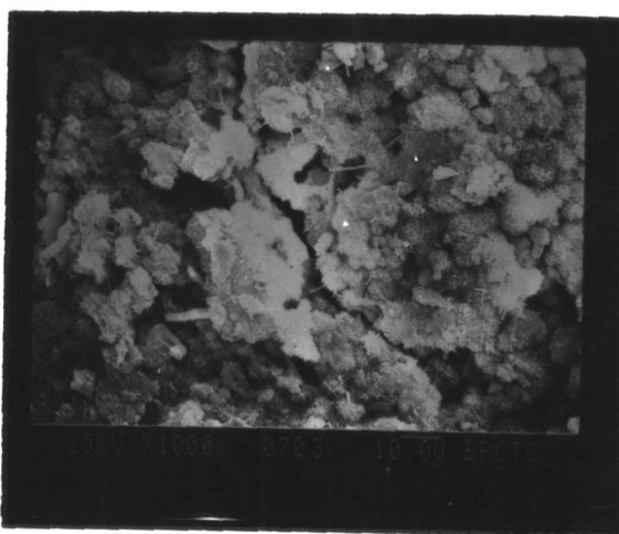
照片3 普通混凝土冻融后水化产物结构中出现裂缝的情况
