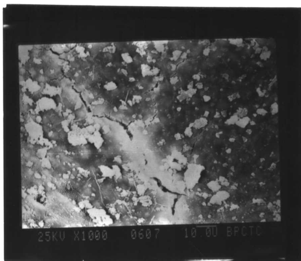
照片8 引气混凝土冻融300循环(动弹下降40%)时,气泡壁裂缝进一步增加和发展的图象。
