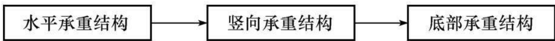
图 1-1 结构的荷载传递框图
