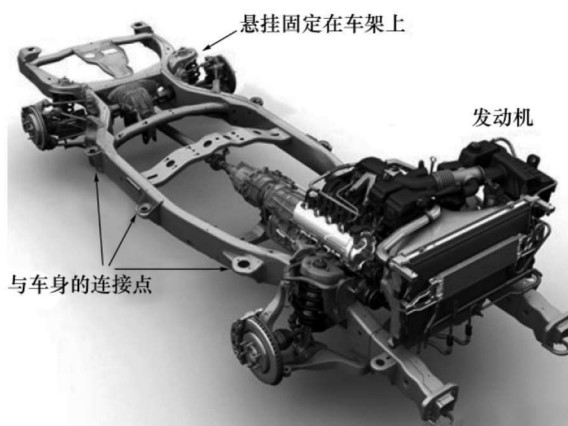
图 1-4 非承载式车架
