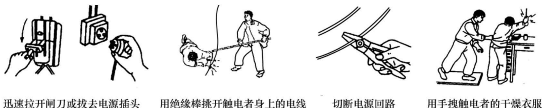
图 1.2 解救触电者脱离低压电源的方法
