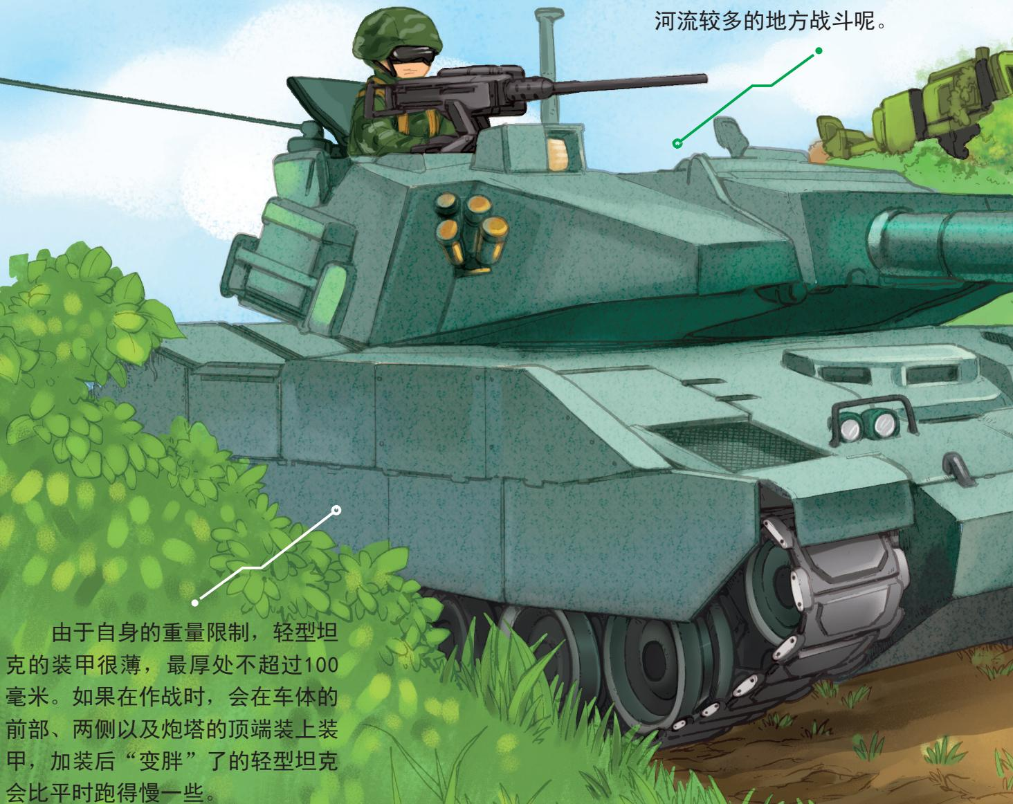
由于自身的重量限制，轻型坦克的装甲很薄，最厚处不超过100毫米。如果在作战时，会在车体的前部、两侧以及炮塔的顶端装上装甲，加装后“变胖”了的轻型坦克会比平时跑得慢一些。
