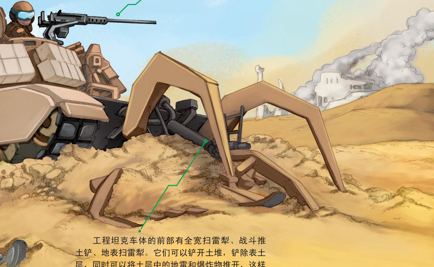
工程坦克车体的前部有全宽扫雷犁、战斗推土铲、地表扫雷犁。它们可以铲开土堆，铲除表土层，同时可以将土层中的地雷和爆炸物推开，这样后面的队伍就能顺利通过了。
