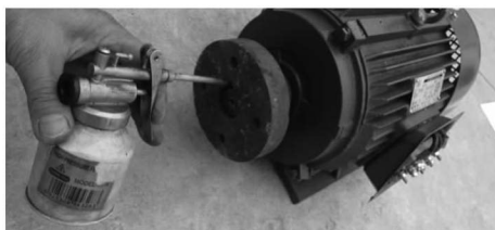
图 1-29 在定位孔内注入煤油
