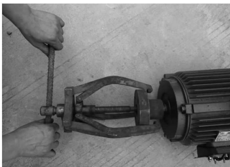
图 1-30 用拉具拉出皮带轮或联轴器
