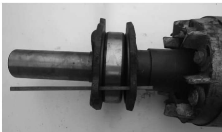
图 1-32 用吊丝法装配轴承外盖
