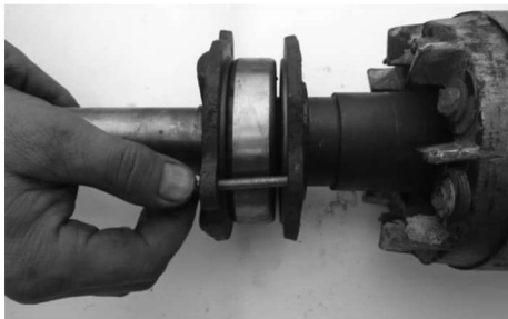
图 1-31 用试探法装配轴承外盖
