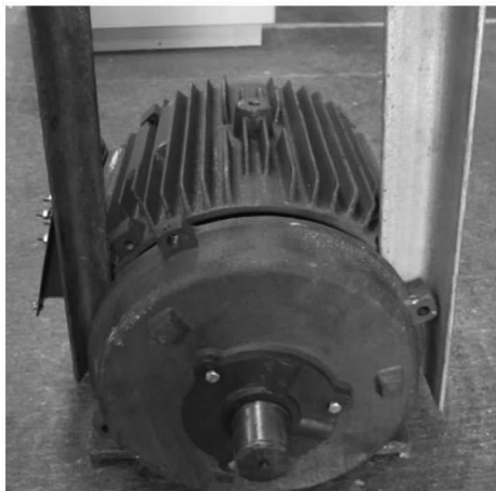
图 1-33 用角铁拆卸端盖
