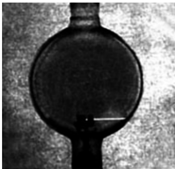
甲 没有磁场时电子束沿直线运动
