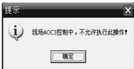
图 1.22 现场 AOC3 控制不允许操作提示界面
