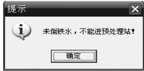
图 1.19 未倒铁水提示界面
