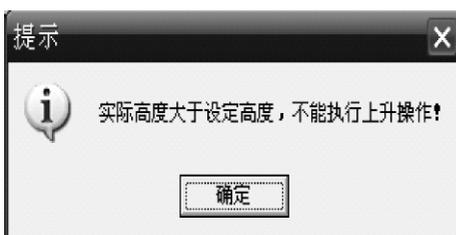
图 1.28 实际高度大于设定高度不能上升操作提示界面
