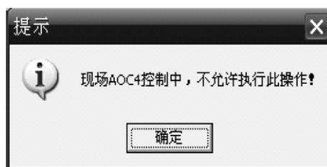
图 1.23 现场 AOC4 控制不允许操作提示界面
