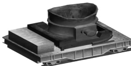
图 1.3 铁水运输车及铁水罐
